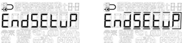
EndSetup ist eine wichtige Funktion, wenn der Zähler sich im Transportmodus befindet, aber wenn der Zähler in Betrieb ist, ist EndSetup nur eine von drei Weisen, auf welcher es möglich ist, die SETUP-Schleife zu verlassen. Siehe Abschnitt 6.3 oben.
