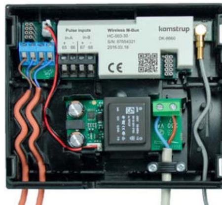
Das Wireless M-Bus-Modul mit angebrachter Zusatzantenne
