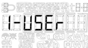
Die USER-Schleife ist die primäre Schleife des Zählers und enthält die legalen und die am häufigsten verwendeten Anzeigen. Die Schleife richtet sich an den Verbraucher und wird nach seinen Bedürfnissen über den DDD-Code konfiguriert. Siehe Abschnitt 3.2.4 für weitere Informationen über die USER-Schleife und die DDD-Codes.
