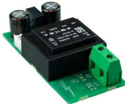
Beim Anschluss an 230 VAC muss die ganze Installation geltenden nationalen Regeln entsprechen. Anschluss/Unterbrechung des Moduls muss vom Zählermonteur ausgeführt werden. Nehmen Sie jedoch zur Kenntnis, dass Arbeiten an Festeinbauten sowie Eingriffe in der Gruppenschalttafel nur durch autorisierte Fachkräfte durchgeführt werden dürfen.
