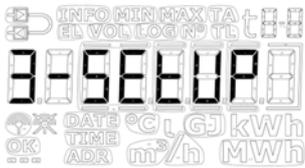
In dieser Schleife kann der Techniker den Zähler über die Fronttasten konfigurieren. Dies ermöglicht dem Techniker, den Zähler sowohl vor der Installation als auch nach der Inbetriebnahme des Zählers zu konfigurieren. Die Konfiguration des Zählers nach der Inbetriebnahme erfordert, dass die Installationsplombe gebrochen und der Oberteil vom Zählerboden getrennt wird.
