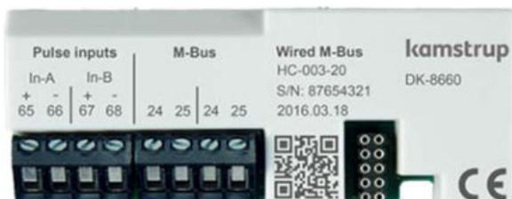
Das Modul ist mit 2 Paar Schraubklemmen für den Anschluss an das M-Bus-Netzwerk ausgestattet. Damit kann das M-Bus-Kabel durch den Zähler geschleift werden, wobei die Anwendung von externen Anschlussboxen vermieden wird. Der Anschluss ist polaritätsunabhängig. Als M-Bus-Kabel muss ein verdrehtes Kupferkabel verwendet werden. Die maximale Kupferschichtdicke beträgt  $\varnothing 1,0$  mm.
