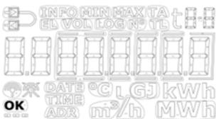
Je nach der Konfiguration des Zählers werden ein oder mehrere Menüpunkte in der SETUP-Schleife im Display „Off“ anzeigen. Dies bedeutet, dass diese Funktionalität im Zähler nicht verfügbar ist, d.h. die Funktion wurde während der Werksprogrammierung deaktiviert. Wenn es versucht wird, über die Sekundärtaste auf diese Anzeigen zuzugreifen, werden die Rahmen um „Off“ sich einschalten, um anzuzeigen, dass diese Funktion im Zähler nicht verfügbar ist.
