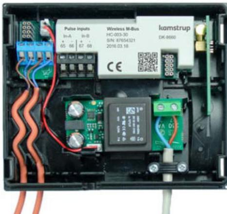
Das Wireless M-Bus-Modul mit angebrachter interner Antenne
